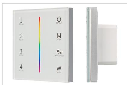
Встраиваемая сенсорная стеклянная панель (2.4 ГГц), цвет белый. Для управления светодиодными RGBW источниками света (ШИМ). Управление цветом с помощью сенсорной полосы. Работает в режиме Master/Slave и может выполнять функцию независимого контроллера. Питание/рабочее напряжение DC 12–24 В, максимальный ток 3 А на канал, 4 канала, максимальная мощность 144–288 Вт. Размеры 86×86×37 мм. Панель совместима с контроллерами серии SMART.
