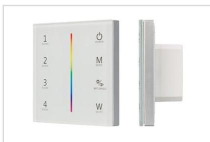
Встраиваемая сенсорная стеклянная панель 2.4 ГГц, белого цвета. Для управления светодиодными RGBW источниками света (ШИМ). Управление цветом с помощью сенсорной полосы. Работает в режиме Master/Slave и может выполнять функцию независимого контроллера. Питание/рабочее напряжение DC 12-24 В, максимальный ток 3 А на канал, 4 канала, максимальная мощность 144-288 Вт. Габариты 86×86×37 мм. Панель совместима с пультами и контроллерами серии SMART.
