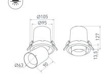
Встраиваемый поворотный выдвигающийся светильник для потолка. Мощность 10 Вт, св. поток 900 лм, 90 лм/Вт, дневной 4000 К, CRI>90, угол 24°, напряжение питания 230 В. Белый круглый корпус из алюминия, экран РС, степень защиты IP20. Монтаж встраиваемый, установочное отверстие Ø95 мм. Драйвер 30–48 В, 250 мА, пульсация <1%. Размеры: Ø105×127 мм.
