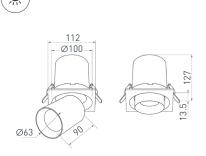
Встраиваемый поворотный выдвигающийся светильник для потолка. Мощность 10 Вт, св. поток 900 лм, 90 лм/Вт, дневной 4000 К, CRI>90, угол 24°, напряжение питания 230 В. Белый квадратный корпус из алюминия, экран РС, степень защиты IP20. Монтаж встраиваемый, установочное отверстие Ø100 мм. Драйвер 30–48 В, 250 мА, пульсация <1%.
