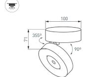
Накладной откидной поворотный светильник 12 Вт. Цвет ДНЕВНОЙ 4000 К, св. поток 800 лм, CRI(Ra)>90, угол излучения 24°, угол поворота 355°, угол наклона 90°. Корпус круглый, черный алюминий, IP40. Питание AC 220–240 В, 12 Вт, драйвер встроенный (DC 300 мА, 25–42 В).
