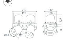
Встраиваемый поворотный выдвигающийся светильник для потолка. Светодиоды 2×10 В, цвет БЕЛЫЙ ДНЕВНОЙ 4000 К, св. поток 1900 лм, угол 24°, RA>90. Белый корпус. Мощность 20 Вт, питание AC 220-240 В. Установка в отверстие 100×195 мм. Драйвера в комплекте (2 шт, 30-48 В, 250 мА).
