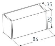
Светильник для магнитных треков шириной 45 мм, 3 Вт. Цвет свечения ДНЕВНОЙ 4000 К, световой поток 226 лм, угол 15°, CRI>90. Прямоугольный металлический корпус черного цвета IP20. Входное напряжение DC 24 В, мощность 3 Вт. Драйвер DC 24 В/AC 230 В поставляется отдельно. Диммируется только с 026407(1), 027633. Размеры: 84×35×43 мм.
