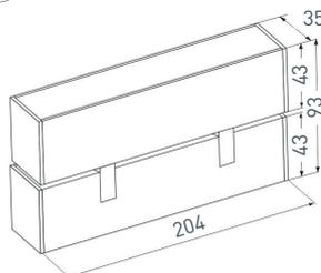
Светильник поворотный для магнитных треков шириной 45 мм, 6 Вт. Цвет свечения ДНЕВНОЙ 4000 К, световой поток 650 лм, угол 100°, CRI>90. Прямоугольный металлический корпус черного цвета IP20. Входное напряжение DC 24 В, мощность 6 Вт. Драйвер DC 24 В/AC 230 В поставляется отдельно. Диммируется только с 026407(1), 027633. Размеры: 204×35×43 мм.
