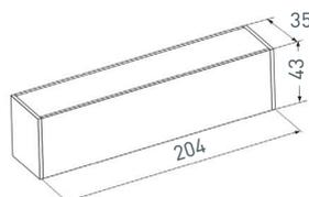
Светильник для магнитных треков шириной 45 мм, 6 Вт. Цвет свечения ДНЕВНОЙ 4000 К, световой поток 662 лм, угол 100°, CRI>90. Прямоугольный металлический корпус черного цвета IP20. Входное напряжение DC 24 В, мощность 6 Вт. Драйвер DC 24 В/AC 230 В поставляется отдельно. Диммируется только с 026407(1), 027633.
