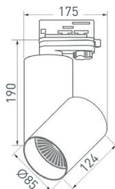
Трековый светильник 15 Вт, черный круглый корпус, белая вставка, металл. Цвет свечения ДНЕВНОЙ 4000 К, св. поток 1100 лм, CRI(Ra)>80, угол 40°. Встроенный драйвер PRI: AC 100–240 В, SEC: DC 350 мА 30–43 В, 15 Вт. Размеры:  $\varnothing 85 \times 124 \times 190 \times 175$  мм.
