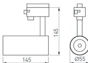
Светильник подвесной для треков/шин, 4 провода, 10 Вт. Цвет свечения ДНЕВНОЙ 4000 К, световой поток 860–1060 лм, угол 24°, CRI>90. Круглый металлический корпус черного цвета. Входное напряжение AC 220–240 В, мощность 10 Вт. Драйвер встроенный (27–38 В, 260 мА). Размеры:  $\varnothing 55 \times 145 \times 145$  мм.
