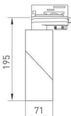
Светильник подвесной для треков/шин, 4 провода. Мощность 15 Вт, св. поток 1100 лм, 74 лм/Вт, дневной 4000 К, CRI>90, угол 30°, напряжение питания 230 В. Черный круглый корпус из алюминия, экран, степень защиты IP40. Монтаж на трек 3-фазный. Драйвер 22–36 В, 350 мА, пульсация <1%. Размеры:  $\varnothing 71 \times 195$  мм.
