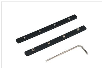
Прямой коннектор для соединения треков MAG-TRACK-45 в линию при подвесном монтаже. Используется в сочетании с коннектором MAG-CON-45-SIDE. Сталь черного цвета. В комплекте 2 коннектора и шестигранный ключ. Размеры: 80×6.2×2 мм.
