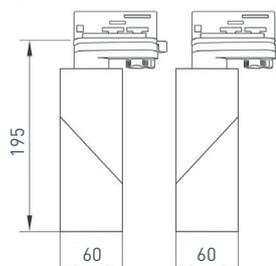
Светильник подвесной для треков/шин, 4 провода, 12 Вт. Цвет свечения ДНЕВНОЙ 4000 К, световой поток 1000 лм, CRI>90, угол свечения 30°, угол регулировки наклона 90°, угол поворота 355°. Прямоугольный металлический корпус белого цвета с черной вставкой, IP40. Питание AC 220–240 В, 12 Вт, драйвер встроенный (DC 300 мА, 25–42 В).
