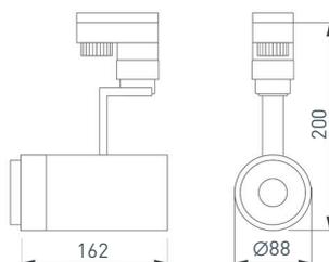
Светильник подвесной для треков/шин, 4 провода, 20 Вт. Цвет свечения ДНЕВНОЙ 4000 К, световой поток 1600–2000 лм, регулируемый угол 20–60°, CRI>90. Круглый металлический корпус белого цвета, IP20. Входное напряжение AC 220–240 В, мощность 20 Вт. Драйвер встроенный (30–42 В, 500 мА).
