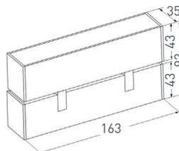
Светильник поворотный для магнитных треков шириной 45 мм, 6 Вт. Цвет свечения ДНЕВНОЙ 4000 К, световой поток 455 лм, угол 15°, CRI>90. Прямоугольный металлический корпус черного цвета, IP20. Входное напряжение DC 24 В, мощность 6 Вт. Драйвер DC 24 В/AC 230 В поставляется отдельно. Диммируется только с 026407(1), 027633.
