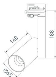
Трековый светильник 8 Вт, черный круглый корпус, цветная вставка, металл. Цвет свечения ДНЕВНОЙ 4000 К, св. поток 570 лм, CRI(Ra)>80, угол 40°. Драйвер встроенный PRI: AC 220–240 В, SEC: DC 200 мА, 30–43 В, 8 Вт. Размеры:  $\varnothing 65 \times 140 \times 188$  мм.
