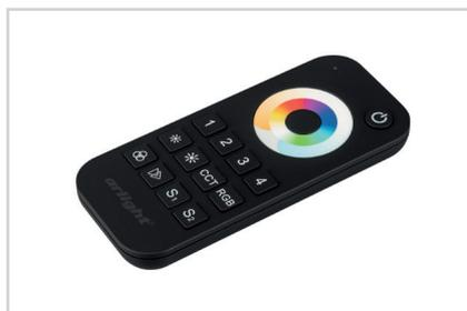
Кнопочный радиопульт с сенсорным кольцом 2.4 ГГц черного цвета для управления DIM/MIX/RGB/RGBW - источниками света. 4 зоны управления, 2 слота памяти пользовательских настроек, выбор цвета и типа управления с помощью сенсорного кольца. Питание DC 3 В (AAA\*2). Изготовлен из пластика с покрытием Soft Touch.
