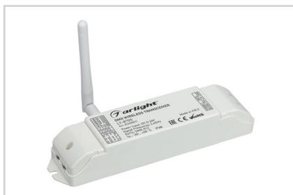
DMX-усилитель (2.4 ГГц, дальность действия 200–300 м), вход или выход DMX512 (в зависимости от назначения), для беспроводной передачи сигнала DMX512 к декодеру DMX и далее к светодиодной RGB-ленте, используются парами, питание 5–24 В.
