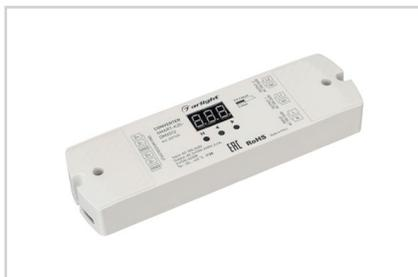
Конвертер сигнала DMX512 в TRIAC. Вход DMX512, выход TRIAC (230 В), напряжение питания AC 230 В. 2 канала управления, ток нагрузки 2×1 А. На корпусе цифровой дисплей. Размеры: 170×50×23 мм.
