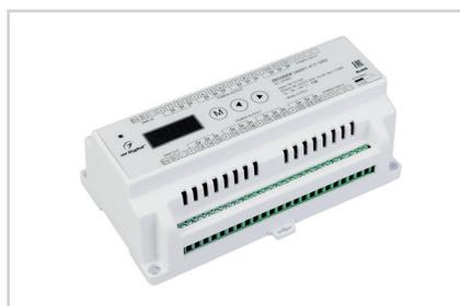
Декодер DMX512 для трансляции DMX512 сигнала ШИМ(PWM) устройствам. Питание DC 12–24 В. 24 канала, ток нагрузки 24×3 А, мощность нагрузки 864–1720 В. Входной сигнал DMX512, выходной сигнал ШИМ(PWM). Цифровой дисплей на корпусе, адрес устанавливается с помощью кнопок. Декодер предназначен для установки на DIN-рейку.
