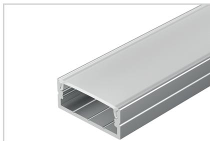
Алюминиевый анодированный накладной профиль для светодиодных лент и линеек. Ширина площадки для ленты 19 мм. Аксессуары приобретаются отдельно. Размеры: 2000×23.5×10 мм.
