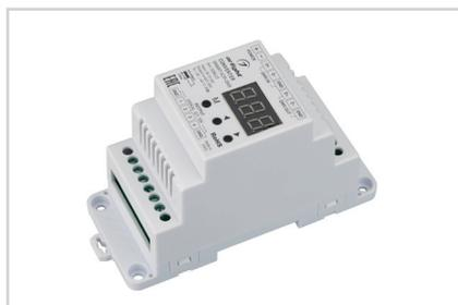
Конвертер сигнала DMX512 в 0/1–10 В. Вход DMX512, выход 0–10 В и 1–10 В (по выбору), напряжение питания DC 12–24 В. На выходе 4 канала, ток нагрузки 20 мА на канал. На корпусе цифровой монитор.
