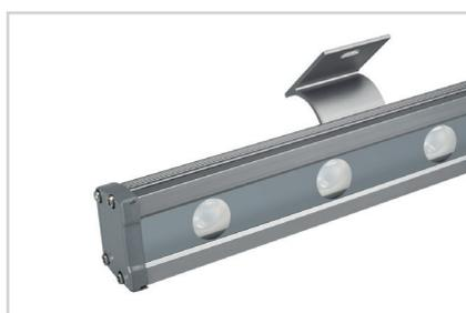
Линейный светодиодный прожектор WALLWASHER. Мощность 48 В, напряжение питания DC 24 В. Количество светодиодов 12 штук. Цвет светодиодов RGB-Day (4000K) (4 кристалла в каждом светодиоде), управление по протоколу DMX512, угол рассеивания 15×45°. Корпус: алюминиевый сплав и армированное стекло. Цвет корпуса серый, степень влагозащиты IP65.
