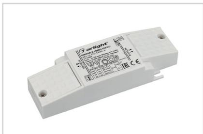
Диммируемый источник тока по стандарту TRIAC с гальванической развязкой для светильников и мощных светодиодов. Входное напряжение AC 220–240 В. Выходные параметры: 26–42 В, 200–350 мА, 15 Вт. Выбор значения тока осуществляется DIP-переключателем. Встроенный PFC>0.92. Негерметичный пластиковый корпус IP20.
