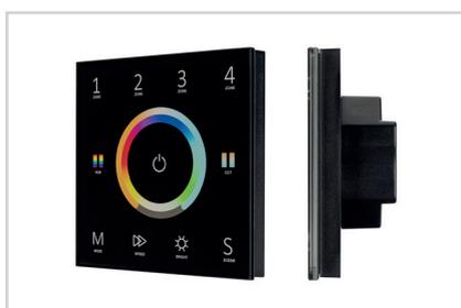
Встраиваемая сенсорная панель 2.4 ГГц, черного цвета из стекла. Для управления RGB+MIX (5-канальными) источниками света (ШИМ), 4 зоны управления. Питание/рабочее напряжение AC 85–265 В. Функция управления DMX512-устройствами. Размеры: 86×86×36 мм.
