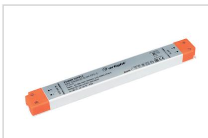
Источник напряжения с гальванической развязкой для светодиодных изделий. Входное напряжение AC 200–240 В. Выходные параметры: 48 В, 0.62 А, 30 Вт. Встроенный PFC>0.9. Сверхтонкий пластиковый корпус IP20. Размеры: 251×30×16 мм.
