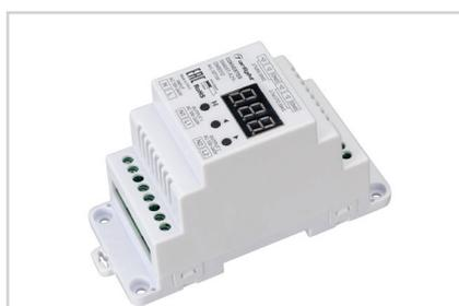
Конвертер сигнала DMX512 в TRIAC. Вход DMX512, выход TRIAC(230 В), напряжение питания AC 230 В. 2 канала управления, ток нагрузки 2×1.2 А. На корпусе цифровой дисплей. Для использования на DIN-рейке.
