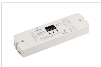
Декодер тока DMX512 для трансляции DMX512-сигнала ШИМ(PWM) устройствам, таким как светильникам и мощным светодиодам. Питание DC 12–48 В. 4 канала, ток нагрузки 4×350 мА, мощность нагрузки 16.8–67.2 В. Входной сигнал DMX512, выходной сигнал ШИМ (PWM). Цифровой дисплей на корпусе, адрес устанавливается с помощью кнопок. Размеры: 170×50×23 мм.
