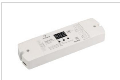
Декодер тока DMX512 для трансляции DMX-512 сигнала ШИМ(PWM) устройствам, таким как светильники и мощные светодиоды. Питание DC 12–48 В. 4 канала, ток нагрузки 4×350 мА, мощность нагрузки 16.8–67.2 Вт. Входной сигнал DMX512, выходной сигнал ШИМ(PWM). Цифровой дисплей на корпусе, адрес устанавливается с помощью кнопок. Размеры: 170×50×23 мм.
