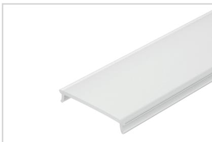
Матовый экран высшего класса для профилей PDS, MIC. Материал PC (поликарбонат), светопропускание 65%. Гладкий, ударопрочный, двойная УФ-защита. Устойчивый к прямому солнечному излучению. Пригоден для использования в любых условиях в помещениях и на улице. Длина 2000 мм.
