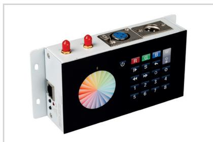
Настенный сенсорный DMX-контроллер, управление кнопками на панели или от смартфона (iOS, Android) или по радиоканалу пультами SR-2818, 2819, 2819 S (поставляются отдельно), до 8 зон. Питание 12 В, выход цифровой сигнал DMX. Подключение лент через любой DMX-декодер. Размеры: 165×78×35 мм.
