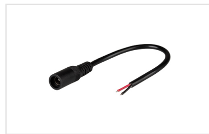
Артикул 022356 Круглый разъем DC 2-pin МАМА для соединения отрезков одноцветных светодиодных лент. Провод 20AWG, длина 150 мм, размер гнезда 2.1 5.5. Максимальный ток 3А. Цена за 1шт.
