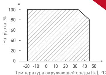
Рис. 3. Максимальная допустимая нагрузка, % от мощности источника.
