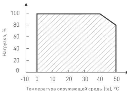
Рис. 2. Максимальная допустимая нагрузка, % от мощности источника
