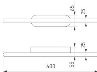
Декоративный настенный светильник. Мощность 13 Вт, св. поток 600 лм, 50 лм/Вт, теплый 3000 К, CRI>90, угол излучения 120°, напряжение питания 230 В. Черный фигурный корпус из алюминия, экран из матового поликарбоната, степень защиты IP54. Монтаж накладной. Пульсация <0.5. Размеры: 600×55×65 мм.
