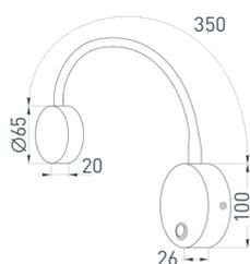
Накладной настенный светильник 3 Вт, черный алюминиевый корпус. Цвет ТЕПЛЫЙ БЕЛЫЙ 3000 К, св. поток 180 лм, CRI(Ra)>80, угол излучения 100°, IP20. Питание AC 220–240 В, 3 Вт, встроенный драйвер. Размеры:  $\varnothing 65.2 \times 20.7, \varnothing 99.5 \times 25.5$  мм.
