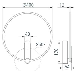
Декоративный настенный светильник. Мощность 13 Вт, св. поток 850 лм, 65 лм/Вт, теплый 3000 К, CRI>80, угол излучения 110°, напряжение питания 230 В. Черный фигурный корпус из алюминия, экран из поликарбоната, степень защиты IP20. Пульсация <0.5%. Возможность поворота светоизлучателя на 350 градусов. Размеры:  $\varnothing 400, 178 \times 43$  мм.
