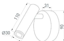
Накладной настенный светильник 3 Вт, алюминиевый корпус в бронзовом цвете без кнопки включения. Цвет ТЕПЛЫЙ БЕЛЫЙ 3000 К, св. поток 200 лм, CRI(Ra)>80, угол излучения 20°, IP20. Питание AC 220–240 В, 3 Вт, встроенный драйвер. Размеры:  $\varnothing 90 \times 31$ ,  $\varnothing 30 \times 110$  мм.
