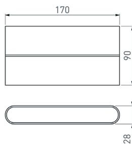
Накладной настенный светильник 2×6 Вт, серый алюминиевый корпус (RAL7024), матовый рассеиватель из поликарбоната. Цвет ТЕПЛЫЙ БЕЛЫЙ 3000 К, св. поток 650 лм, CRI(Ra)>80, угол 120°, свет вверх-вниз, IP54. Питание AC 220–240 В, 12 Вт, встроенный драйвер. Размеры: 170×90×28 мм.
