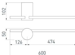
Настенный светильник со свечением в верхнюю или нижнюю полусферу. Мощность 3 Вт, св. поток 170 лм, 55 лм/Вт, теплый 3000 К, CRI>90, угол 40°, напряжение питания 230 В. Золотой фигурный корпус из алюминия, степень защиты IP20. Монтаж накладной. Драйвер 1.8–4 В, 700 мА, пульсация <1%. Размеры: 60×38.5×62 мм.
