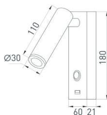
Накладной настенный светильник 3 Вт, черный алюминиевый корпус. Цвет ТЕПЛЫЙ БЕЛЫЙ 3000 К, св. поток 200 лм, CRI(Ra)>80, угол излучения 20°, IP20. Питание AC 220–240 В, 3 Вт, встроенный драйвер. Встроенный USB-порт для зарядки. Размеры: 180×60×21,  $\varnothing 30 \times 110$  мм.
