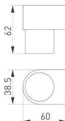
Настенный светильник со свечением в верхнюю или нижнюю полусферу. Мощность 3 Вт, св. поток 170 лм, 55 лм/Вт, теплый 3000 К, CRI>90, угол излучения 40°, напряжение питания 230 В. Золотой фигурный корпус из алюминия, степень защиты IP20. Монтаж накладной. Драйвер 1.8–4 В, 700 мА, пульсация <1%. Размеры: 60×38.5×62 мм.
