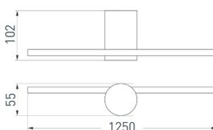
Декоративный настенный поворотный светильник с креплением в центре корпуса. Мощность 12 Вт, св. поток 400 лм, 37 лм/Вт, теплый 3000 К, CRI>80, угол излучения 110°, напряжение питания 230 В. Черный фигурный корпус из алюминия, экран из поликарбоната, степень защиты IP20. Монтаж накладной. Драйвер 5–12 В, 700 мА, пульсация <0.5%. Драйвер 5–12 В, 700 мА, пульсация <0.5%. Возможность поворота светоизлучателя на 355 градусов. Размеры: 1250×55×102 мм.
