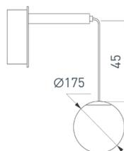
Накладной откидной светильник 16 Вт, черный круглый корпус. Цвет ДНЕВНОЙ 4000 К, св. поток 1328 лм, CRI(Ra)>90, угол излучения 110°. Питание AC 220–240 В, 16 Вт, драйвер встроенный (400 мА, 30–42 В). Поворачивается вокруг своей оси на 350° и отклоняется на 90°. Размеры:  $\varnothing 175 \times 38$  мм,  $\varnothing 95 \times 45$  мм.
